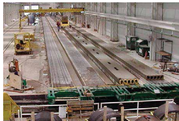
Dây chuyền sản xuất cọc / panel rỗng Hollow cored Panel / Pile Production Line Quatity: 01 set
